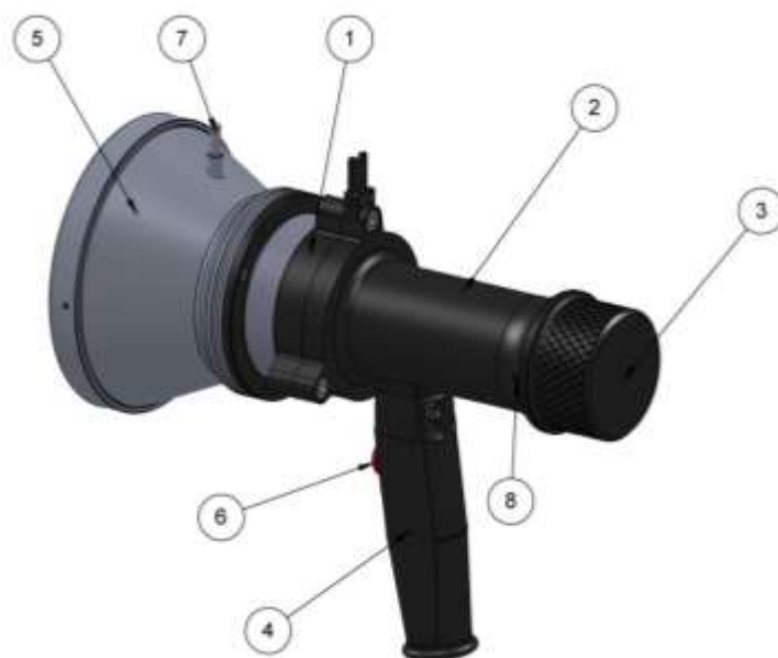
Рис. 1. Имитатор пламени (вид сбоку)
